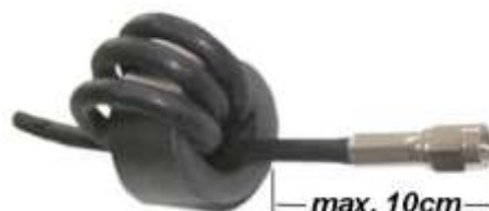
Bild 3: Montage des Ringkerns auf der Antennenzuleitung
